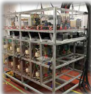
SST Module 150kVA, 1-1 kVdc 250 kHz
