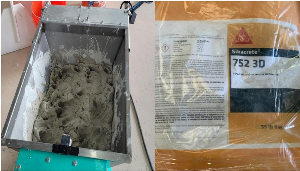
**Figure 1.** Sikacrete<sup>R</sup> -752 3D micro-concrete
